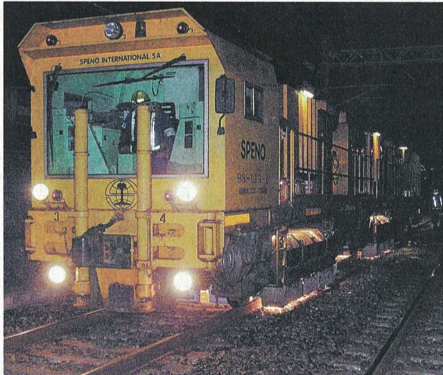
砥石(といし)付きの車輪で火花を散らしながらレールを削る削正車(神戸市提供)
